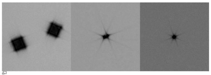
Testaufnahmen eines hellen Sterns erstellt mit der Scheinerblende (von links nach rechts zunehmend bessere Fokussierung)
