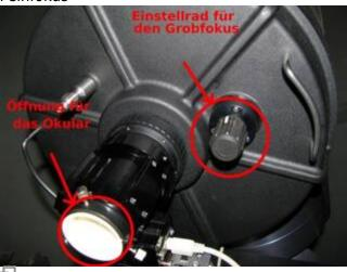
Grobfokus (Die weiße Staubschutzkappe wurde mittlerweile durch einen schwarzen Stutzen ersetzt, welcher ein Trockenmittel beherbergt um das Teleskop vor Feuchtigkeit zu schützen.)
