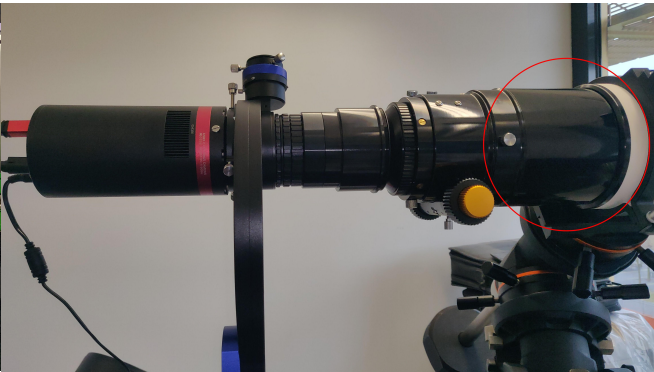
Falsches Setup mit Verlängerungshülse
