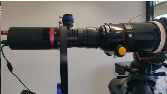
Falsches Setup mit Verlängerungshülse
