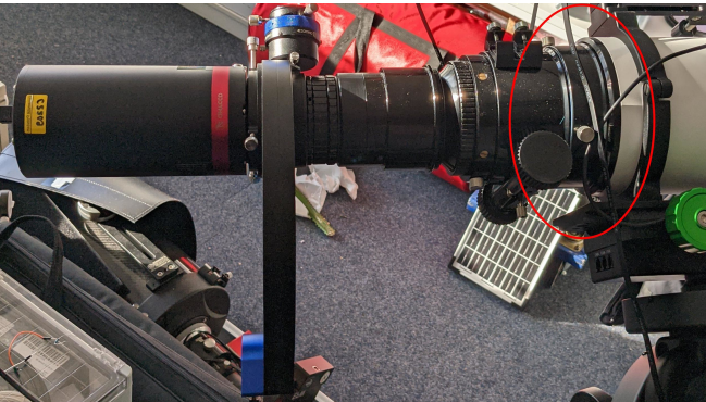
Korrektes Setup ohne Verlängerungshülse
