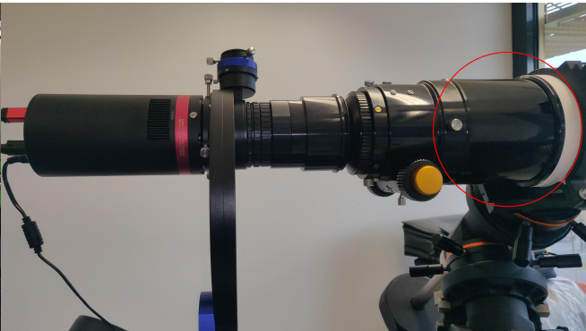
Falsches Setup mit Verlängerungshülse
