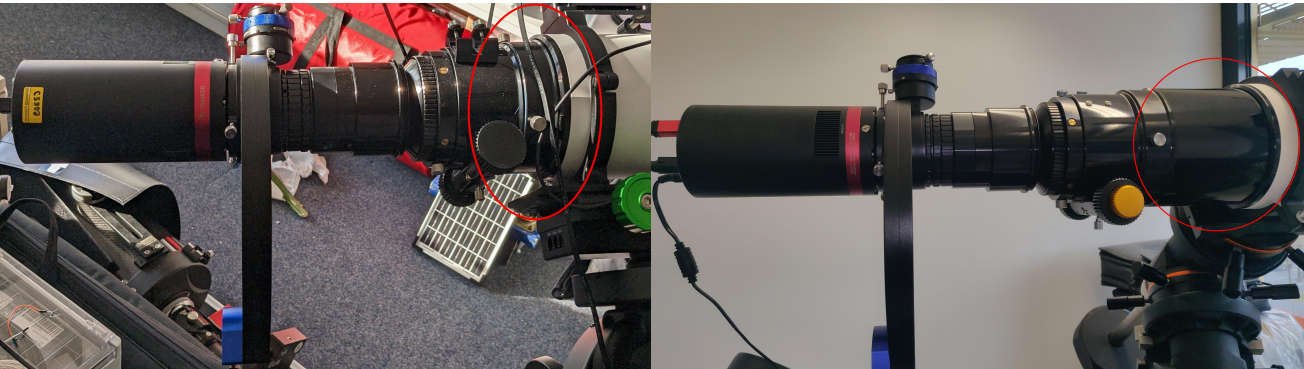
Korrektes Setup ohne Verlängerungshülse Falsches Setup mit Verlängerungshülse
