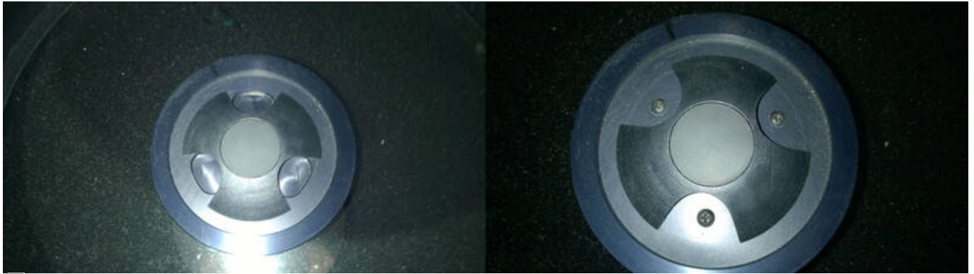
Sekundärspiegel (rechts mit gedrehter Abdeckung, sodass die Einstellschrauben sichtbar sind)
