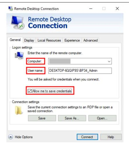
Durch einen Klick auf Connect kann dann die Verbindung hergestellt werden. Anschließend wird man nach den Anmeldeinformationen gefragt und bei erfolgreicher Eingabe die Verbindung etabliert.
