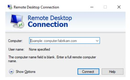
Anschließend kann unter Computer die IP oder die URL des Observatory Management System (OMS) eingegeben werden. Des Weiteren muss der User name gesetzt werden, welcher sich aus dem Rechnername und dem Accountname wie folgt zusammensetzt:
