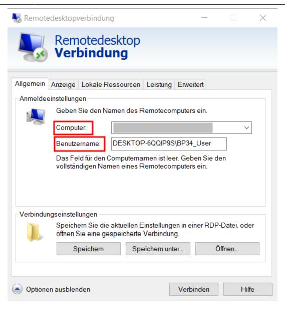
Durch einen Klick auf Verbinden kann dann die Verbindung hergestellt werden. Anschließend wird man nach den Anmeldeinformationen gefragt und bei erfolgreicher Eingabe die Verbindung etabliert.
