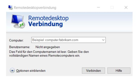
Anschließend kann unter Computer die IP oder die URL des Observatory Management System (OMS) eingegeben werden. Des Weiteren muss der Benutzername gesetzt werden, welcher sich aus dem Rechnername und dem Accountname wie folgt zusammensetzt:
