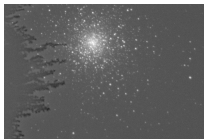
Aufnahme des Sternhaufen M15 mit der ST-8. An der linken Seite ist deutlich das Eis auf dem CCD-Chip zu erkennen.
