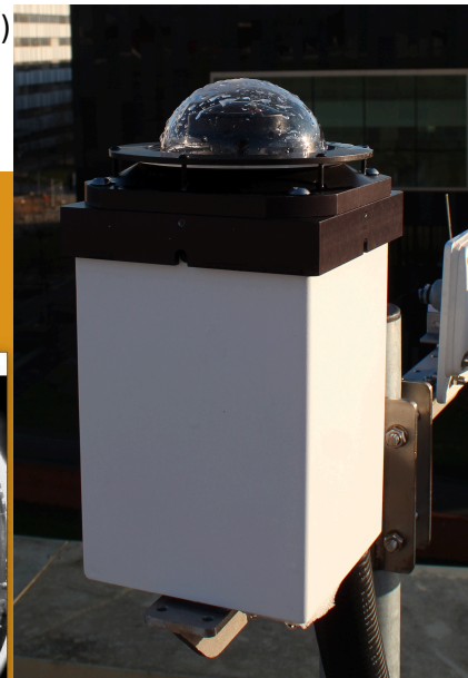
AllSky-340 von SBIG mit ein bisschen Restfeuchtigkeit vom letztem Regen auf dem Dome
