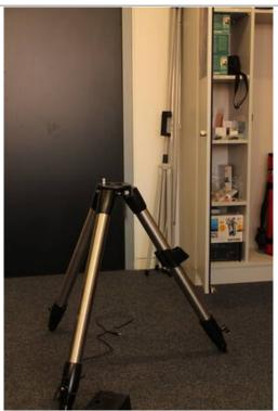
Die Scheibe zur Stabilisierung fixiert die Stativbeine an der Innenseite. Die Stange, die die Scheibe durchsticht, wird mit dem Gewinde von unten in den Stativsockel geschraubt und zwar soweit, bis das Gewinde auf der anderen Seite vollständig durch ist. Die Stange sollte sich nun vertikal bewegen lassen.
