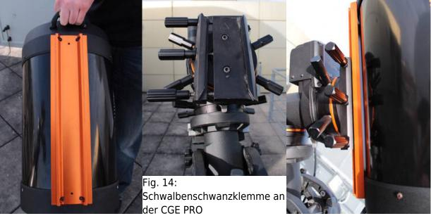
Fig. 13: Schwalbenschwanz am Tubus
