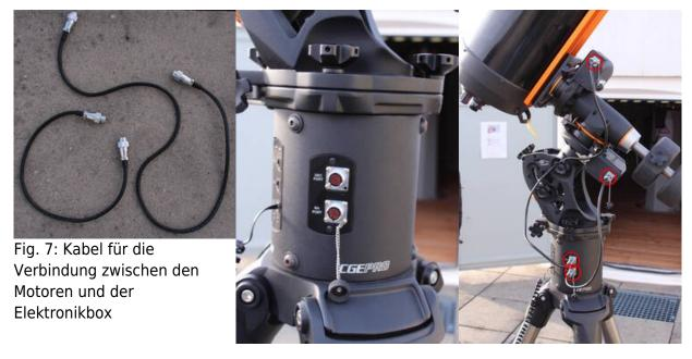
Fig. 9: CGE PRO mit den hergestellten Kabelverbindungen zur Elektronikbox
