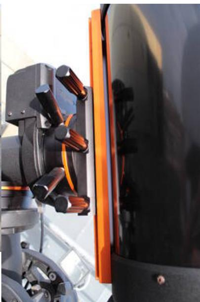
Fig. 15: Montage des C11 an der CGE PRO
