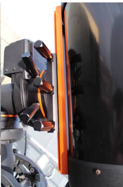
Fig. 15: Montage des C11 an der CGE PRO
