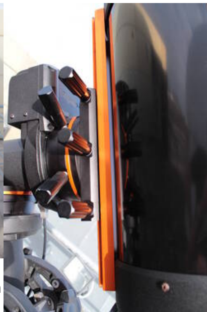
Fig. 15: Montage des C11 an der CGE PRO
