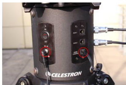
Fig. 12: Anschlüsse für das Netzteil (links) und das Handterminal (rechts) an der
