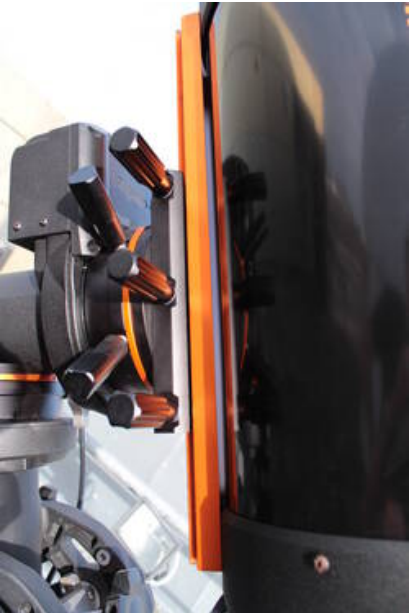
Fig. 15: Montage des C11 an der CGE PRO
