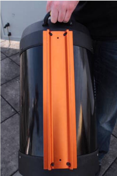
Fig. 13: Schwalbenschwanz am Tubus
