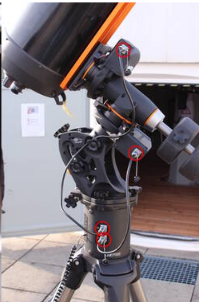
Fig. 9: CGE PRO mit den hergestellten Kabelverbindungen zur Elektronikbox
