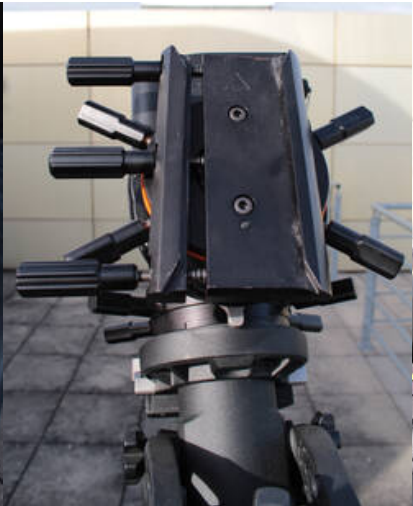
Fig. 14: Schwalbenschwanzklemme an der CGE PRO
