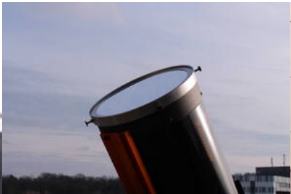
Fig. 17: Tubus mit Sonnenfilter
