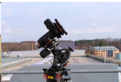
Fig. 5: CGE PRO aufgesetzt auf die Elektronikbox und das Stativ (die roten Kreise markieren die Schrauben welche die CGE PRO an der Elektronikbox fixieren)
