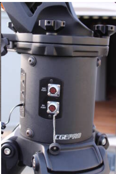
Fig. 8: Elektronikbox mit den Anschlüssen für die Kabel zu den Rektaszensions- und Deklinationsmotoren
