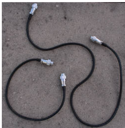
Fig. 7: Kabel für die Verbindung zwischen den Motoren und der Elektronikbox
