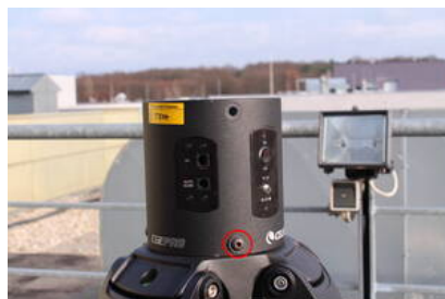
Fig. 2: Stativ mit der Elektronikbox der CGE PRO (der rote Kreis markiert eine der Schrauben welche die Elektronikbox am Stativ fixiert)
