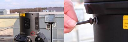
Fig. 2: Stativ mit der Elektronikbox der CGE PRO (der rote Kreis markiert eine der Schrauben welche die Elektronikbox am Stativ fixiert)
