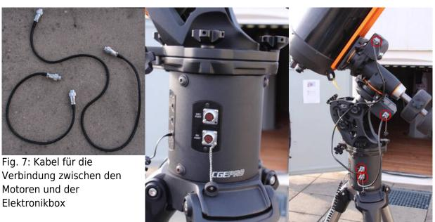
Fig. 8: Elektronikbox mit den Anschlüssen für die Kabel zu den Rektaszensions- und Deklinationsmotoren
