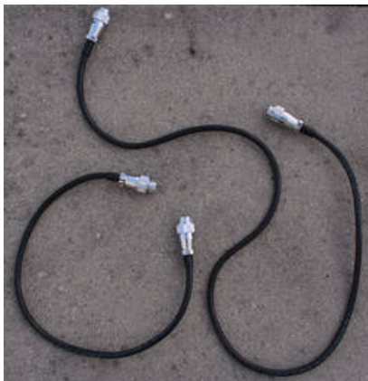
Fig. 7: Kabel für die Verbindung zwischen den Motoren und der Elektronikbox
