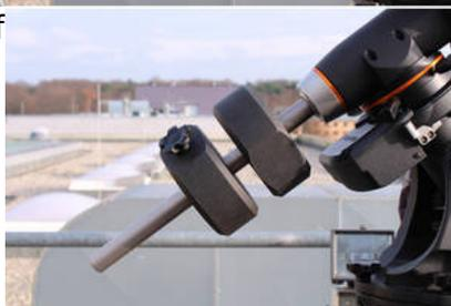
Fig. 6: CGE PRO mit montierter Gegengewichtsstange sowie den Gegengewichten
