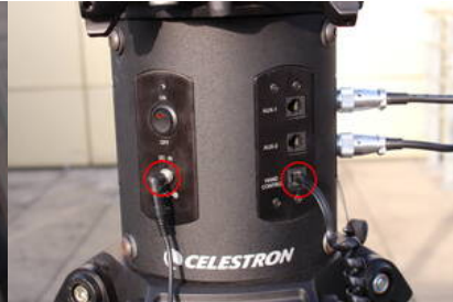
Fig. 12: Anschlüsse für das Netzteil (links) und das Handterminal (rechts) an der Elektronikbox
