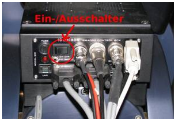
Steuereinheit an der Montierung
