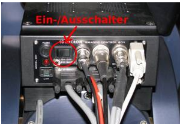
Steuereinheit an der Montierung
