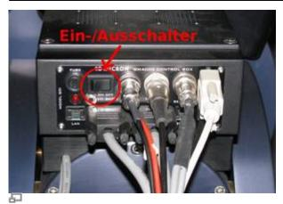
Steuereinheit an der Montierung
