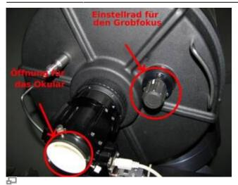
Grobfokus (Die weiße Staubschutzkappe wurde mittlerweile durch einen schwarzen Stutzen ersetzt, welcher ein Trockenmittel beherbergt, um das Teleskop trocken zu halten.
