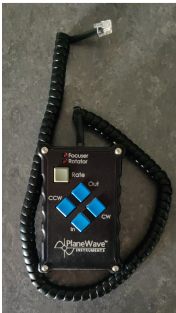
Fig. 1: Handterminal für den Okularauszug
