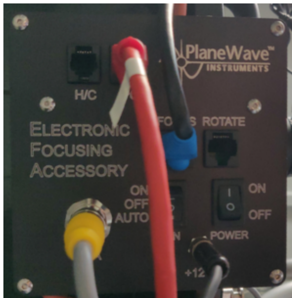
Fig. 2: Die Kontrollbox des Okularauszugs
