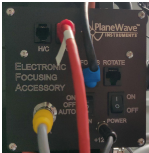
Abb. 2: Die Kontrollbox des Okularauszugs
