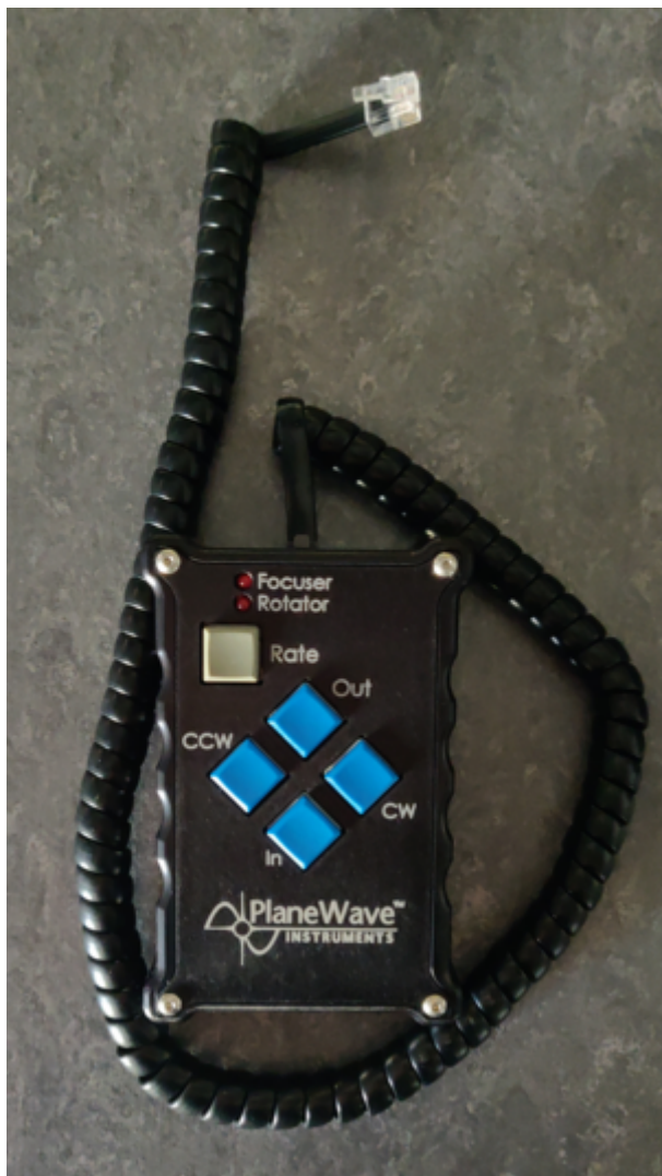
Abb. 1: Handterminal für den Okularauszug
