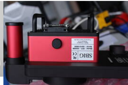
9. STF-8300 mit Filterrad, OAG und eingesetzter ST-i
