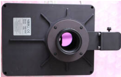
7. Filterrad samt Steckhülse
