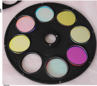
3. Filterhalterung mit Filter und Distanzringen
