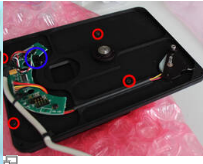
2. Filterradgehäuse befestigen (die roten Kreise markieren die entsprechenden Schrauben, der blaue Kreis markiert den Sensor für die Filterpositionen)
