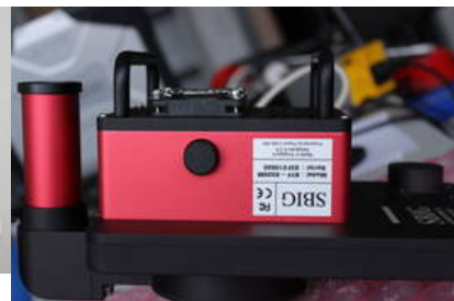
9. STF-8300 mit Filterrad, OAG und eingesetzter ST-i
