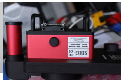
9. STF-8300 mit Filterrad, OAG und eingesetzter ST-i
