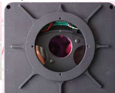
5. Filterrad mit Abdeckung
