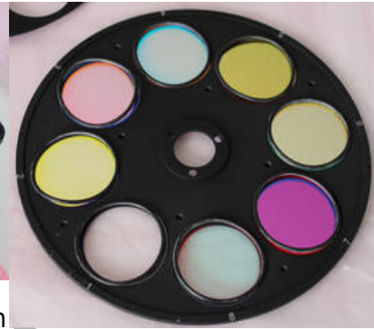
3. Filterhalterung mit Filter und Distanzringen
