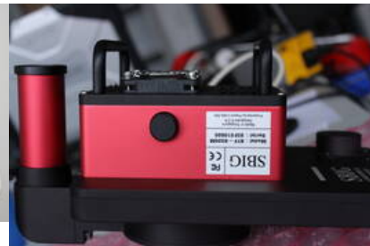
9. STF-8300 mit Filterrad, OAG und eingesetzter ST-i
