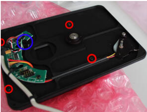
2. Filterradgehäuse befestigen (die roten Kreise markieren die entsprechenden Schrauben, der blaue Kreis markiert den Sensor für die Filterpositionen)
