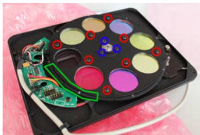
4. Filterrad mit eingebauter Filterhalterung (die roten Kreise markieren die Schrauben, welche die Abdeckung der Filterhalterung sichern, während die blauen Kreise die Schrauben markieren mit der die Filterhalterung im Gehäuse des Filterrades verschraubt sind)
