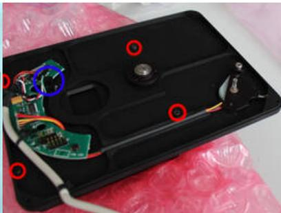
2. Filterradgehäuse befestigen (die roten Kreise markieren die entsprechenden Schrauben, der blaue Kreis markiert den Sensor für die Filterpositionen)
