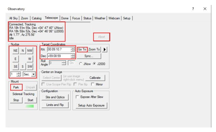
Über die Buttons in der **Nudge**-Sektion kann das Teleskop manuell gefahren werden, wobei die Schrittweite über die Dropdown-Menüs ausgewählt werden kann. Jede Bewegung kann wiederum über
