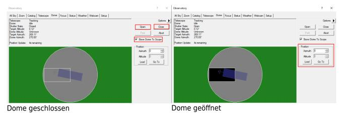
Über die Funktionen in der Box **Position** lässt sich der Dome manuell fahren. Dies ist insbesondere dann nützlich, wenn das Teleskop und der Spalt mal wieder nicht korrekt zueinander ausgerichtet sind und der Dome neu kalibriert werden muss. Auf dem oben gezeigten Beispiel ist die Ausrichtung zwar nicht optimal aber dennoch so gut, dass das Teleskop nicht auf den Dome schaut.
