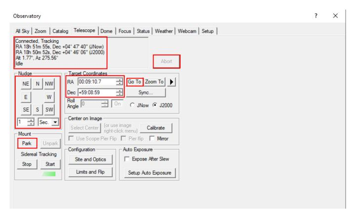
Über die Buttons in der **Nudge**-Sektion kann das Teleskop manuell gefahren werden, wobei die Schrittweite über die Dropdown-Menüs ausgewählt werden kann. Jede Bewegung kann wiederum über den Button **Abort** abgebrochen werden.
