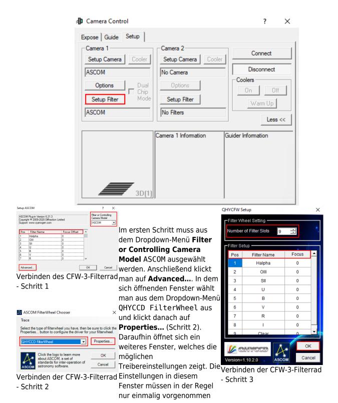
werden. Auszuwählen sind die **Number of Filter Slots** (in unserem Fall sind das 9) und die jeweiligen Filternamen sowie etwaige Korrekturen für den Fokus (Schritt 3). Danach müssen alle drei Fenster durch einen Klick auf **OK** bestätigt und geschlossen werden.
