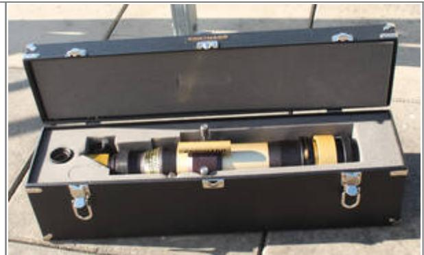
An der Unterseite befindet sich eine Schwalbenschwanzmotierung passend zur Celestron Advanced GT Montierung des C8
