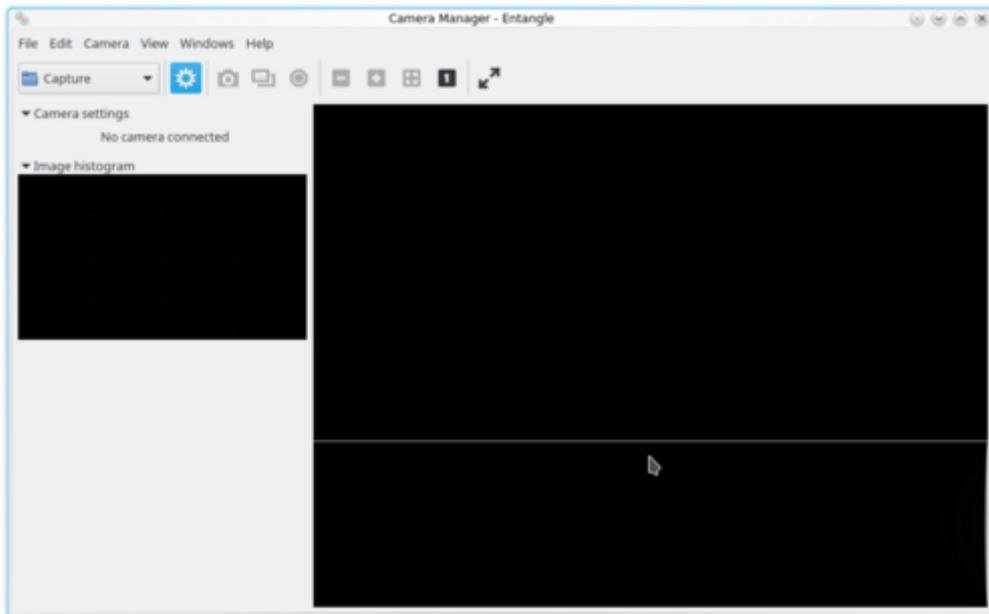
Um eine Verbindung aufzubauen, findet sich im Menü *Camera* der Punkt *Connect*. In einem kleinen Fenster wird nun eine Liste aller verfügbaren Kameras aufgeführt. Mit einem Klick auf *Connect* sollte das Programm die Verbindung herstellen.
